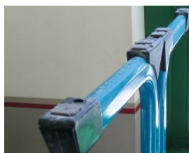
Scharfkantige, beschädigte, abgenutzte und ungeeignete, verschmutzte Stuhlgleiter
