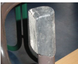
Scharfkantige, beschädigte, abgenutzte und ungeeignete, verschmutzte Stuhlgleiter
