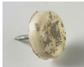
Nylongleiter mit starker Schmutzanhaftung nach achtmonatiger Nutzung
