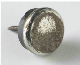
Metallgleiter mit Schmutzanhaftungen nach siebenmonatiger Nutzung
