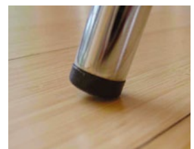
Ungünstige Geometrie führt zu hoher Punktlast
