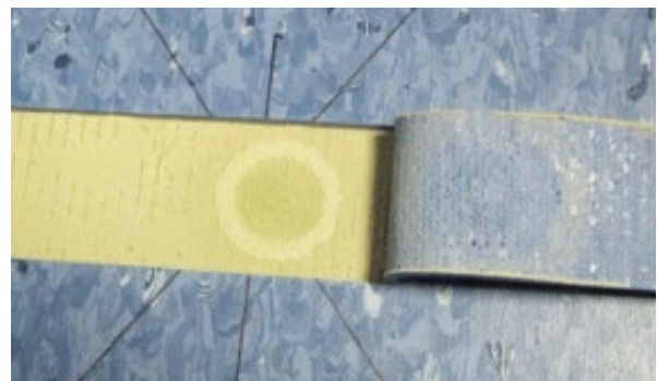
Abb. 6: Klebstoffverquetschung nach Belastung [1]
